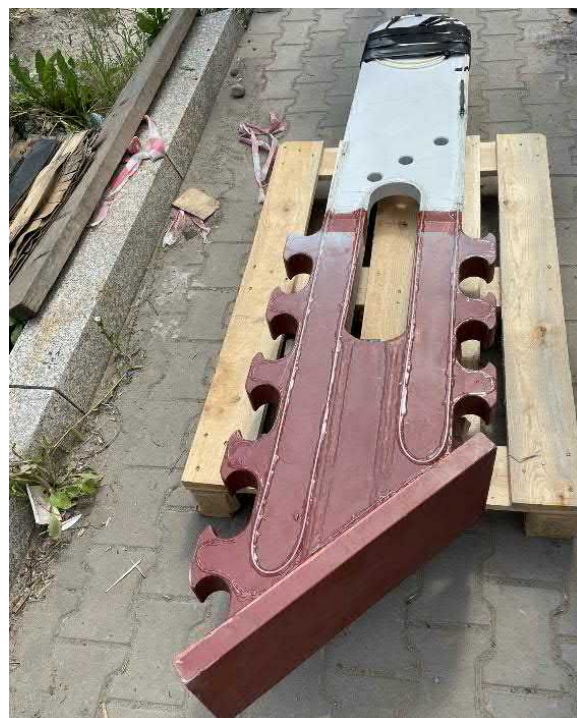
Fot. 1 Zakotwienie dolne wieszaka z naklejonymi światłowodami do pomiaru odkształceń
