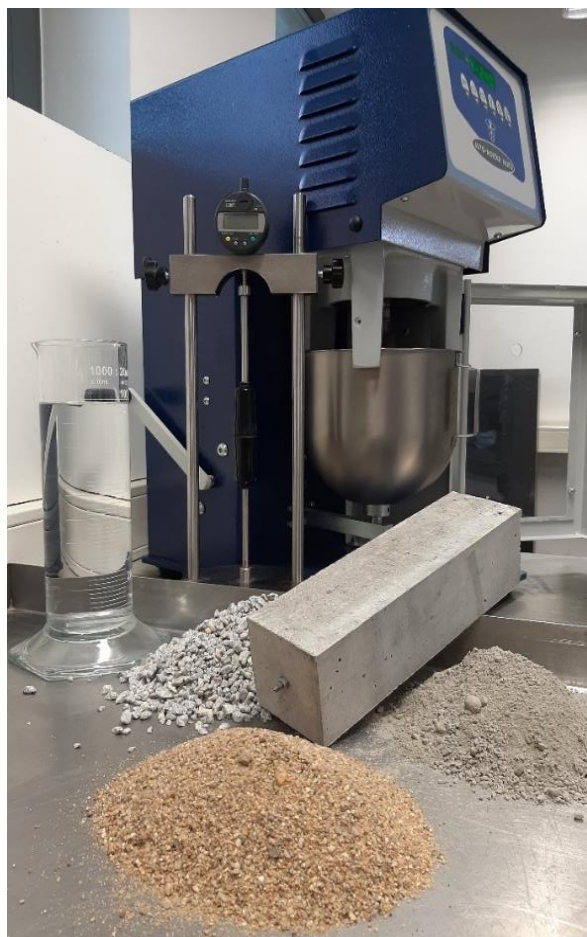
Próbka przygotowana do badania wg PB/2/18
