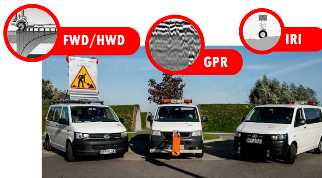
Sprzęt do diagnostyki i oceny stanu technicznego dróg oraz lotnisk
