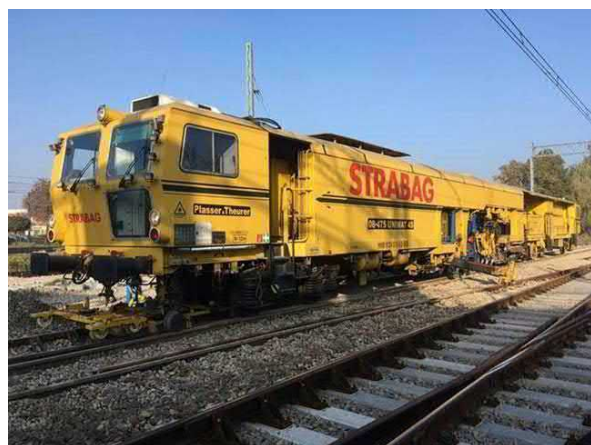
Podbijarka rozjazdowa Unimat 08-475 4S – Gdańsk, rok 2020
